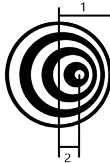
Рис. 6. Кольцевое тестовое изображение: 1 – радиус изображения, 2 – смещение центра кольцевых элементов относительно центра изображения [1, 2]
